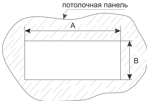
отверстие для установки динамика в стену
